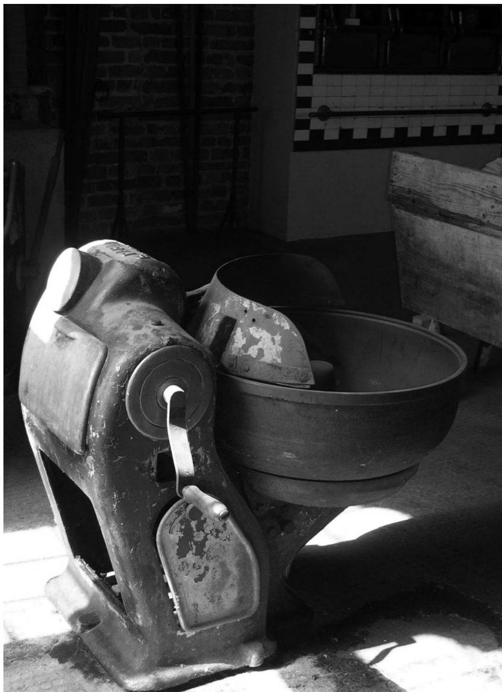
Impastatrice da pane, a motore, con possibilità di movimentazione manuale (Museo del grano e del pane, S. Angelo Lodigiano)
